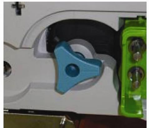
3. Markierung auf 3 Uhr Position drehen – Grundposition Flipper.
